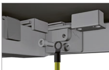
Point de connexion de prise en terre (pour éviter l'accumulation de charge électrostatique).
